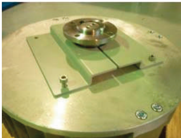
VITE M8x25 TCEI INOX (già presente sul motore) ROND. GROWER D.8 (già presente sul motore)
